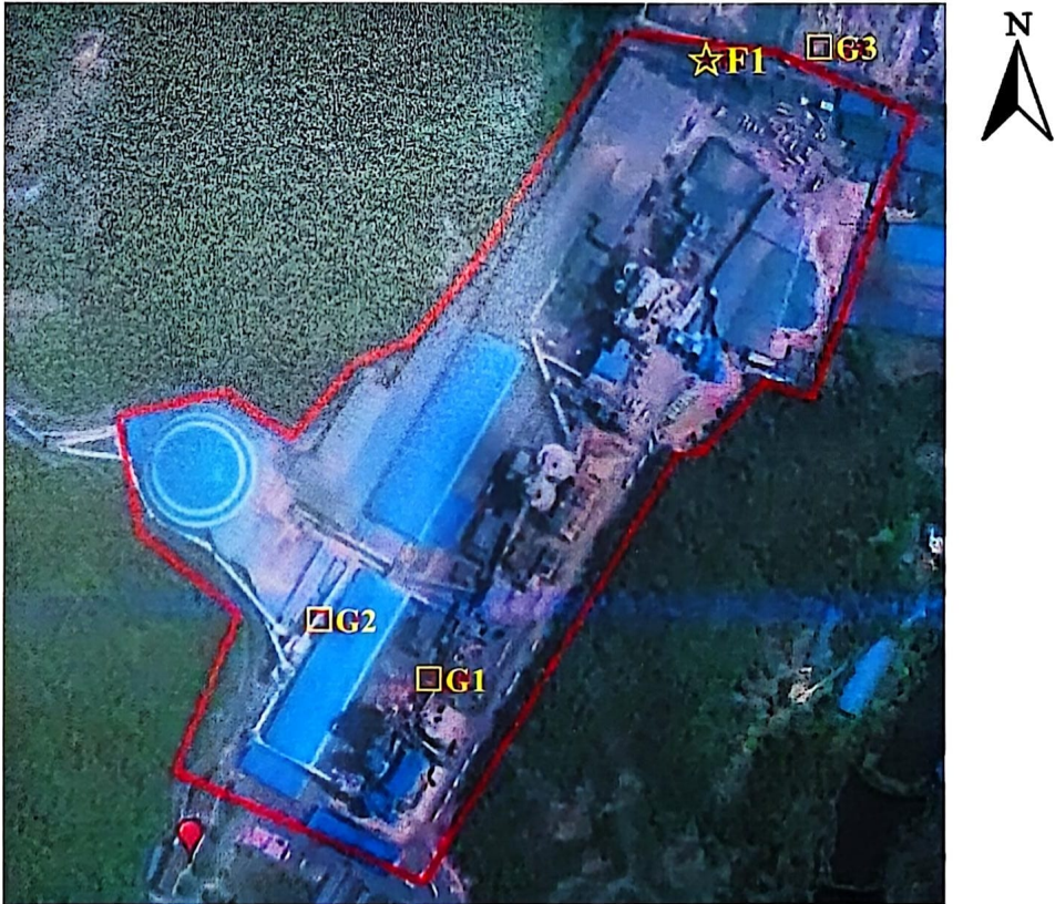
图例：☆—地下水监测点，□——土壤监测点
